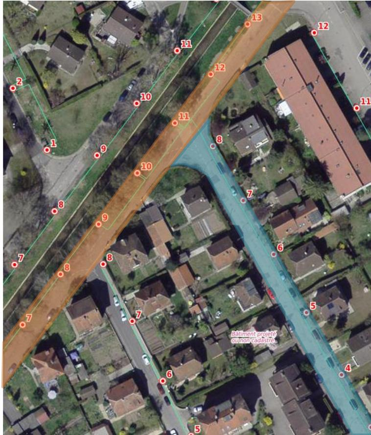
Figure 3: Plan d'une partie du réseau d'éclairage public
